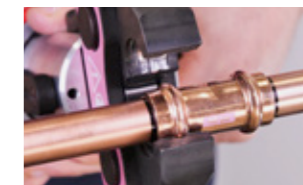
9. Lijn de klemmen recht uit op de fitting
