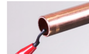
3. Gebruik een potloodtype ontbramer voor de binnenranden
